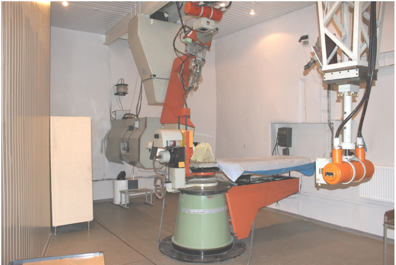
Рис. 7. Центр ПЛТ ИТЭФ. Лучевая установка для облучения внутричерепных злокачественных новообразований
